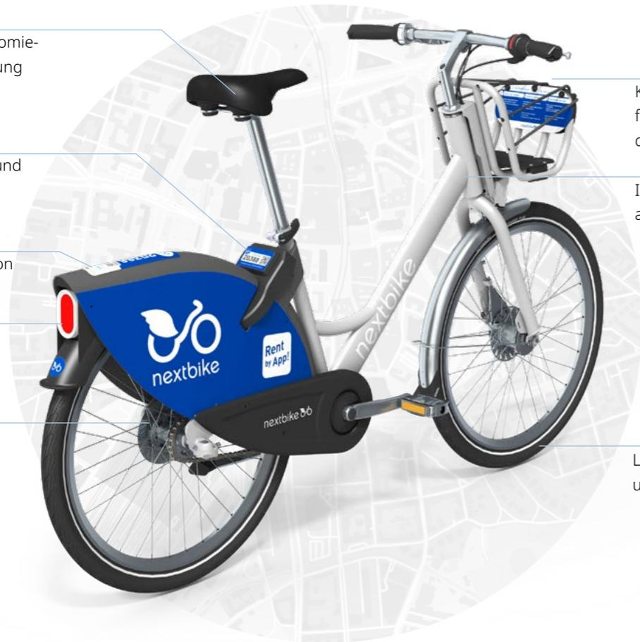
Korb mit Solarmodul für die Aufladung des Rahmenschlosses
